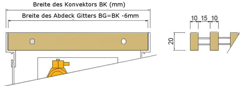
Konvektor Gitter, Quer, rollbar, Ausführung Edelstahl
