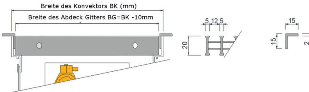
Konvektor Gitter Quer, rollbar, Dural Ausf. mit 'Z' Leiste
