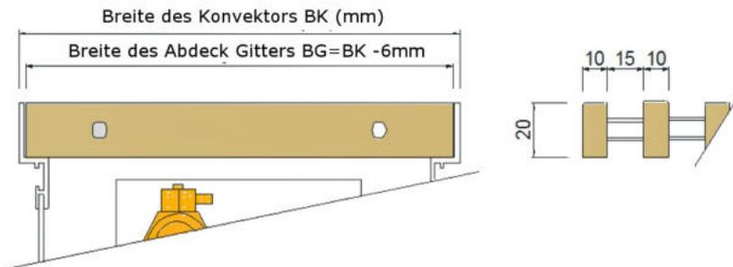
Konvektor Gitter, Quer, rollbar, Ausführung Edelstahl
